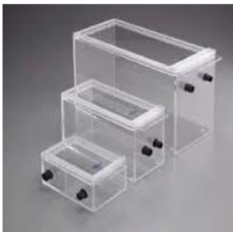
Рис. 2. Камера для проведения ингаляционной анестезии по открытому контуру
