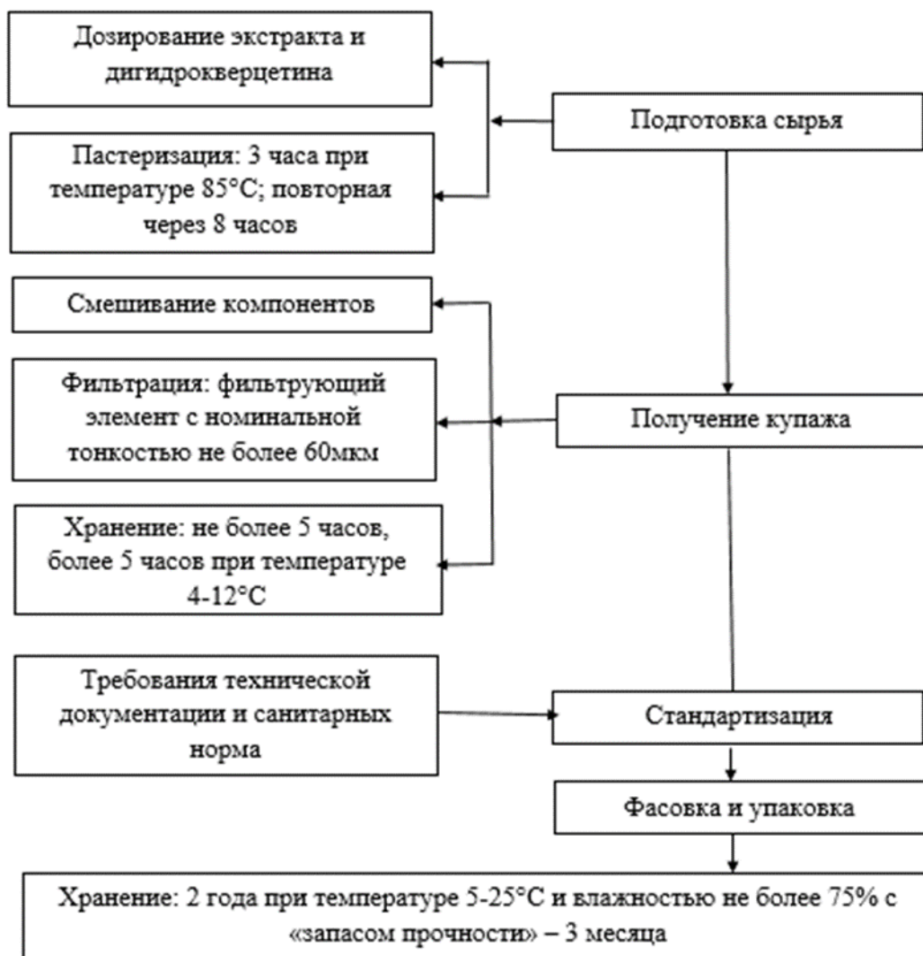
Рисунок 1 – Технологическая схема получения биокомплекса «Популин с дигидрокверцетином»
